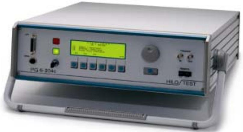
混合波形发生器 PG 6-204 为一冲击电流/冲击电压混合波形发生器，对高阻抗负载  $R_L > 100\Omega$ ，产生标准的冲击电压波形 1.2/50 $\mu$ s；对短路输出，产生标准的 8/20 $\mu$ s 的冲击电流。
